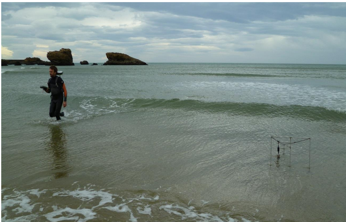
Relevé topo-bathymétrique de la Grande Plage de Biarritz pour évaluer les mouvements sédimentaires et les évolutions morphodynamiques de la plage
