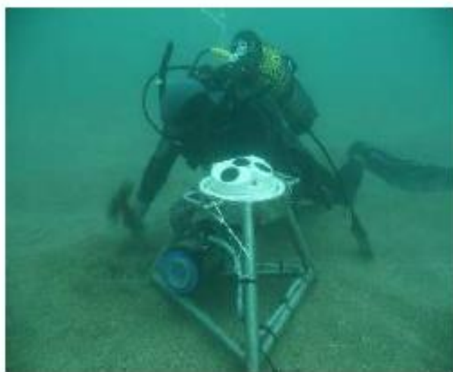
Deux courantomètres seront immergés respectivement à 10 mètres et 20 mètres de profondeur au large de Biarritz pour une période de 3 mois en 2017
