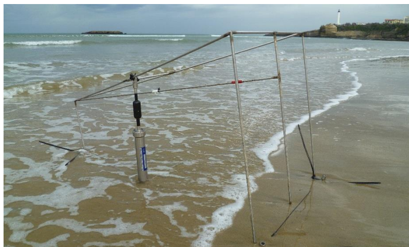
Des capteurs de pression (à gauche) et des capteurs de vitesse (à droite) sont disposés sur la plage pour mesurer les niveaux d'eau, les fréquences et les directions des vagues.
