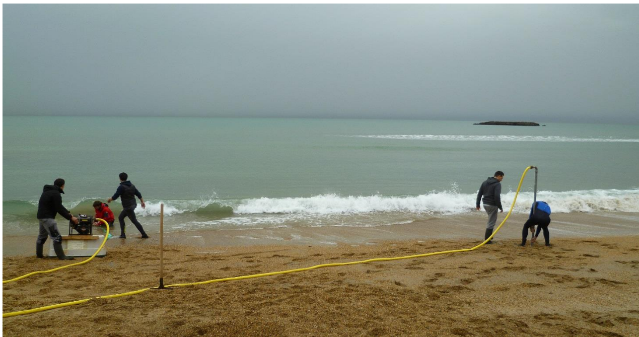
Les partenaires du projet MAREA installent des capteurs océanographiques à l'aide d'une pompe hydraulique sur la Grande Plage de Biarritz pour étudier et mesurer les conditions de la houle lors des tempêtes
