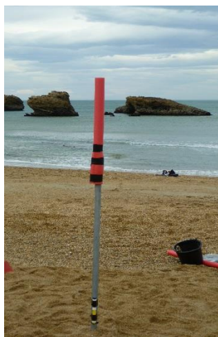
Des capteurs de pression (à gauche) et des capteurs de vitesse (à droite) sont disposés sur la plage pour mesurer les niveaux d'eau, les fréquences et les directions des vagues.
